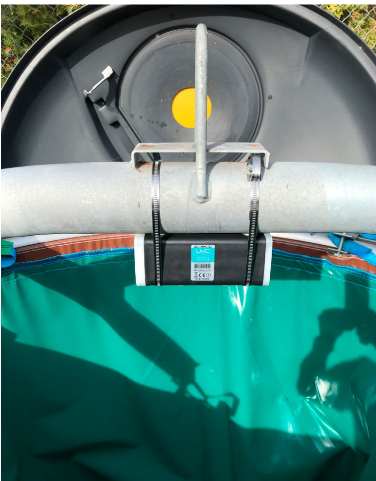
AVFALLSCONTAINERER. En sensor i søppelcontaineren varsler kommunen når det er behov for tømning
