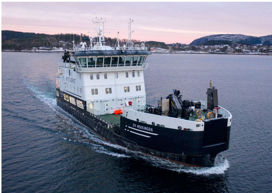
OV Hekkingen kan gå en hel arbeidsdag kun på batteridrift
