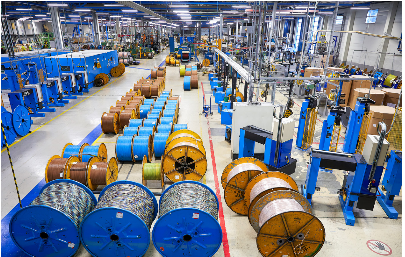
PVC-FRI. For å fjerne PVC og halogener fra kablene sine har Nexans bygget om produksjonslinjene på fabrikken på Langhus
