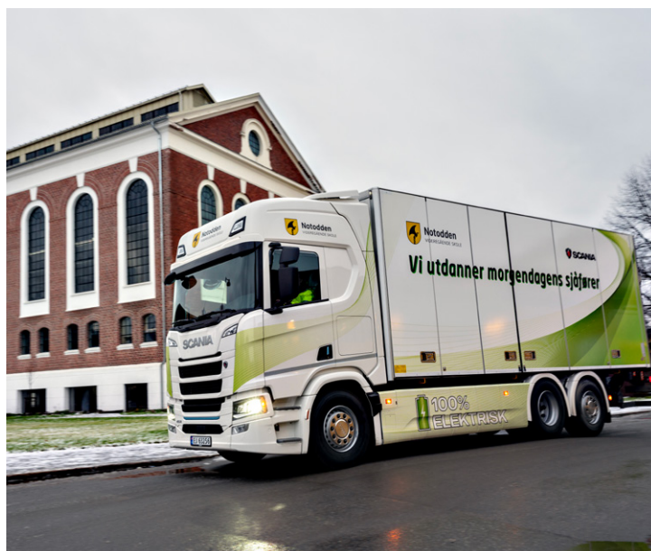
ELEKTRISK YRKESJÅFØRROPPLÆRING. Med tilskudd fra Telemark fylkeskommune sitt klimafond får yrkessjåfør-elevene ved Notodden videregående skole opplæring med toppmodellen av Scania sine elektriske lastebiler. Den har tre elektriske motorer med en samlet systemeffekt på 450 kW.
